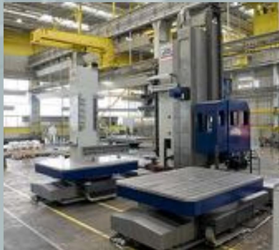
PCE (Posto di Comando Mobile) certificato CE per Alesatrici. Corsa Verticale 5000-9000mm e Orizzontale 1000-1500mm
